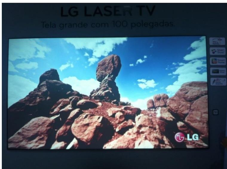
Figura 16. Laser TV, 100 polegadas - equipada com capacidade de SmartTV e TV digital é composta por uma tela imersiva e um projetor externo UST (Ultra Short Throw), capaz de exibir imagens a distâncias curtas, com qualidade Full HD 1080p. Crédito: Joubert Brito.
